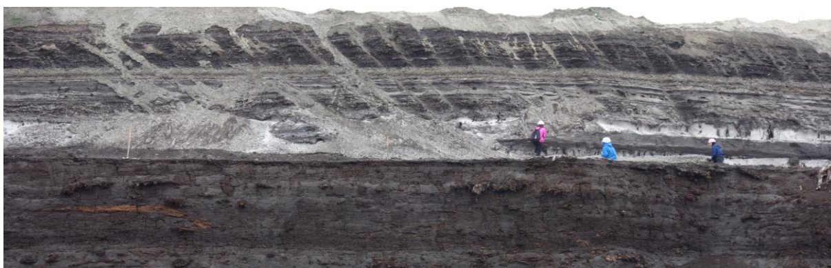
Ryc. 2.14. Ogólny widok horyzontalnie warstwowanych osadów międzywęglowych w obrębie 1. ŚPWB przykrytych przez osady czwartorzędowe w odkrywce Tomistawice (czerwiec, 2023)
